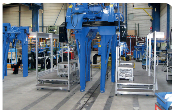
Plate-forme de travail sur lignes d'assemblage
