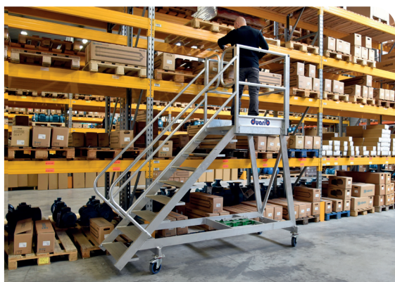
Plate-forme d'accès sécurisé aux rayonnages
