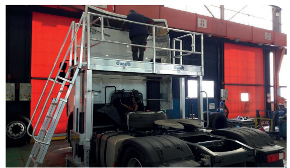
Plate-forme de maintenance pour camions
