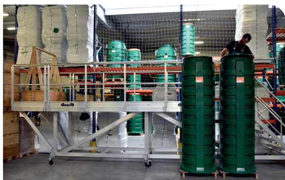
Plate-forme de maintenance pour cuves d'assainissement
